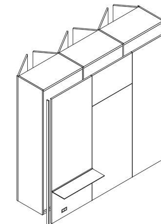
I pannelli boiserie devono essere finiti ai lati con sagome di finitura per boiserie retro armadio, larghezza mm 14. La boiserie retro armadio, ad altezza unica o sovrapposta, può essere attrezzata (escluso specchio) con una sola mensola Code per pannello, con e senza luce a led (p 280-300, spessore 8), con il modulo di cablaggio per una presa elettrica o due prese usb o con gli specchi Drop, Circle e Audrey.
