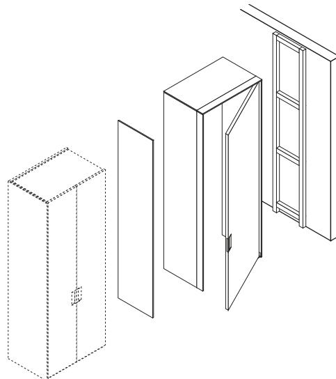
Per l'accostamento del portale alla parete è necessario utilizzare un telaio a parete predisposto per fissare lo stipite. Telaio con regolazione telescopica, spessore da 35 a 55.
