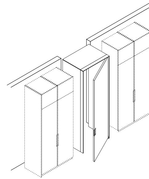
La struttura delle colonne della cucina viene predisposta per il fissaggio del portale.
