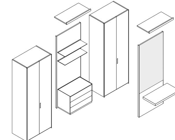
I pannelli boiserie devono essere finiti ai lati con i profili mm 4 e completati con un coperchio superiore, con e senza luce a led. La boiserie (escluso specchio) può essere attrezzata con mensole, contenitori, modulo di cablaggio per una presa elettrica o due prese usb e mensoloni sospesi Code, con e senza luce a led.
