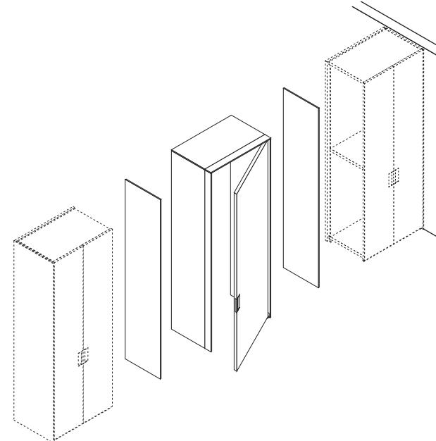
Per l'accostamento del portale all'armadio è necessario utilizzare un fianco interno spessore 15, predisposto per fissare lo stipite, al posto del fianco laterale di serie.
